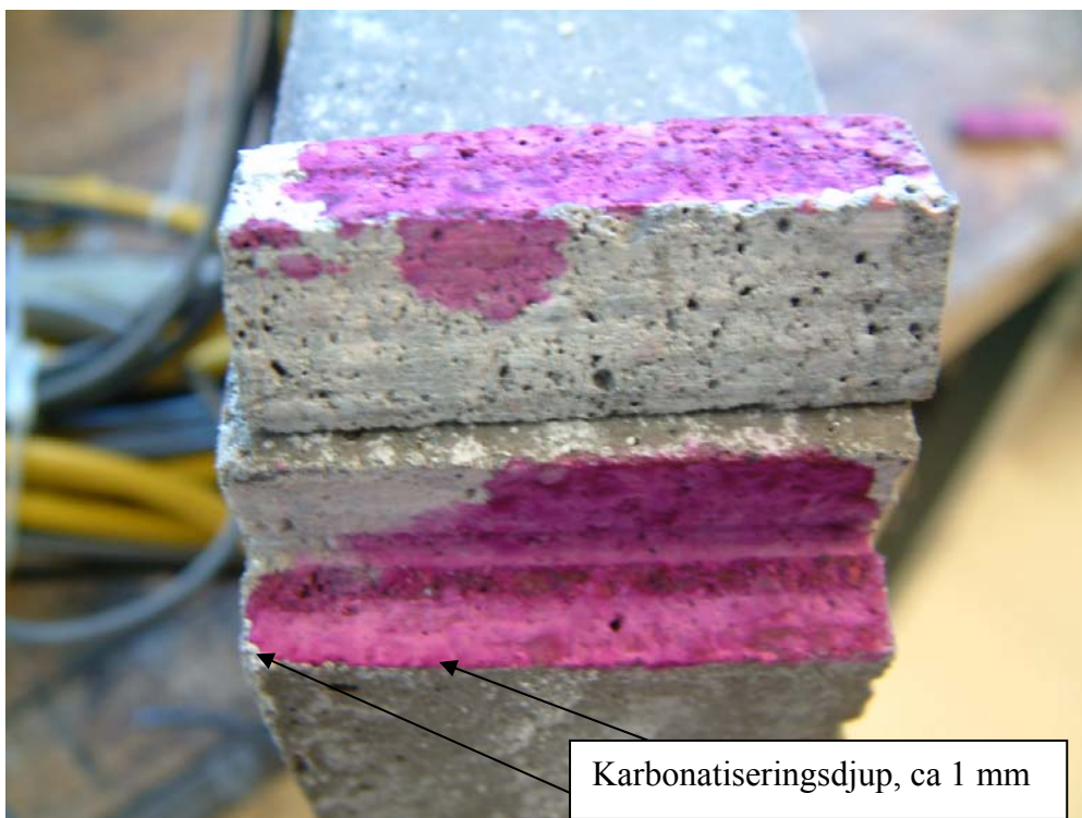
Figur 11. Maximalt karbonatiseringsdjup efter 6 veckors karbonatisering i 99,5 % CO_2 uppmätt med fenoftaleinlösning (ej karbonatiserad betongyta är rödfärgad).
